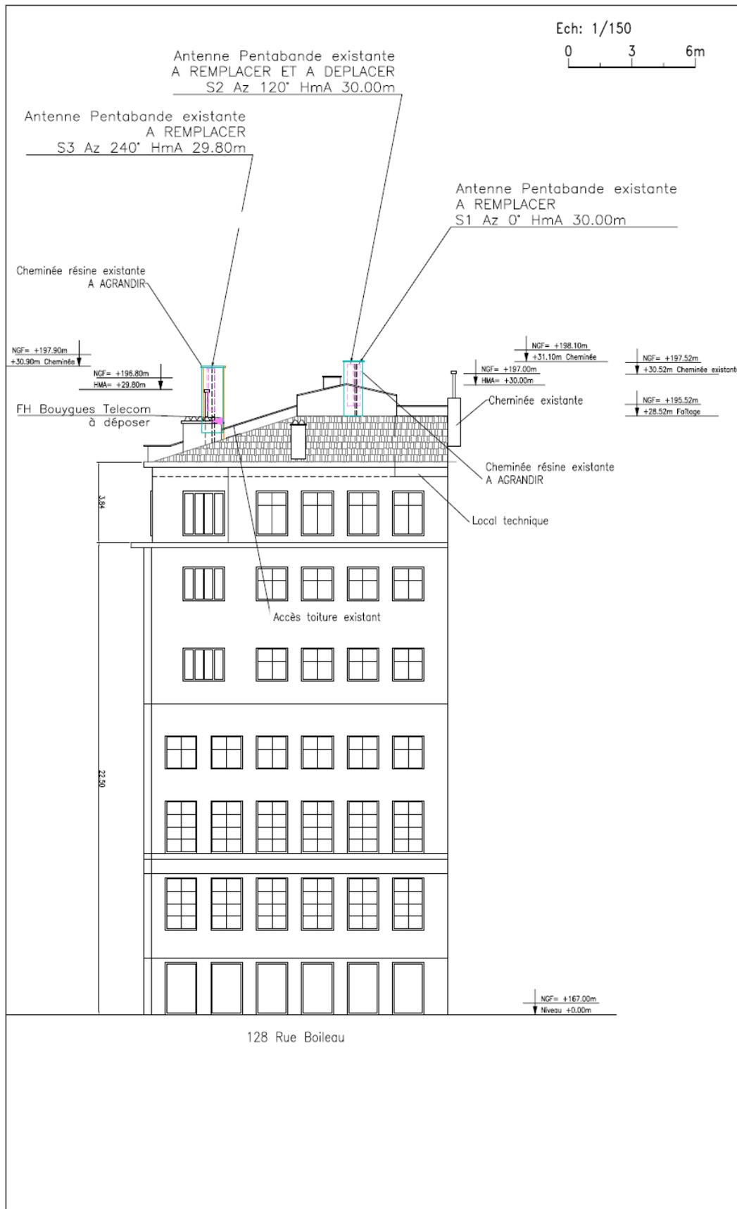
**PLAN EN ELEVATION DE L'INSTALLATION EXISTANTE**
